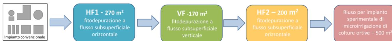
Figure 1: Schéma de la station de démonstration de phyto-épuration hybride de Scicli (RG)
