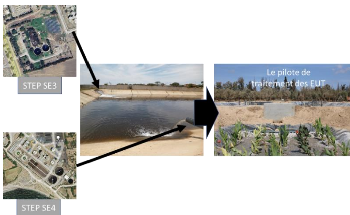
Figure 3. Schéma d'alimentation du pilote par les eaux usées traitées à partir des stations d'épuration
